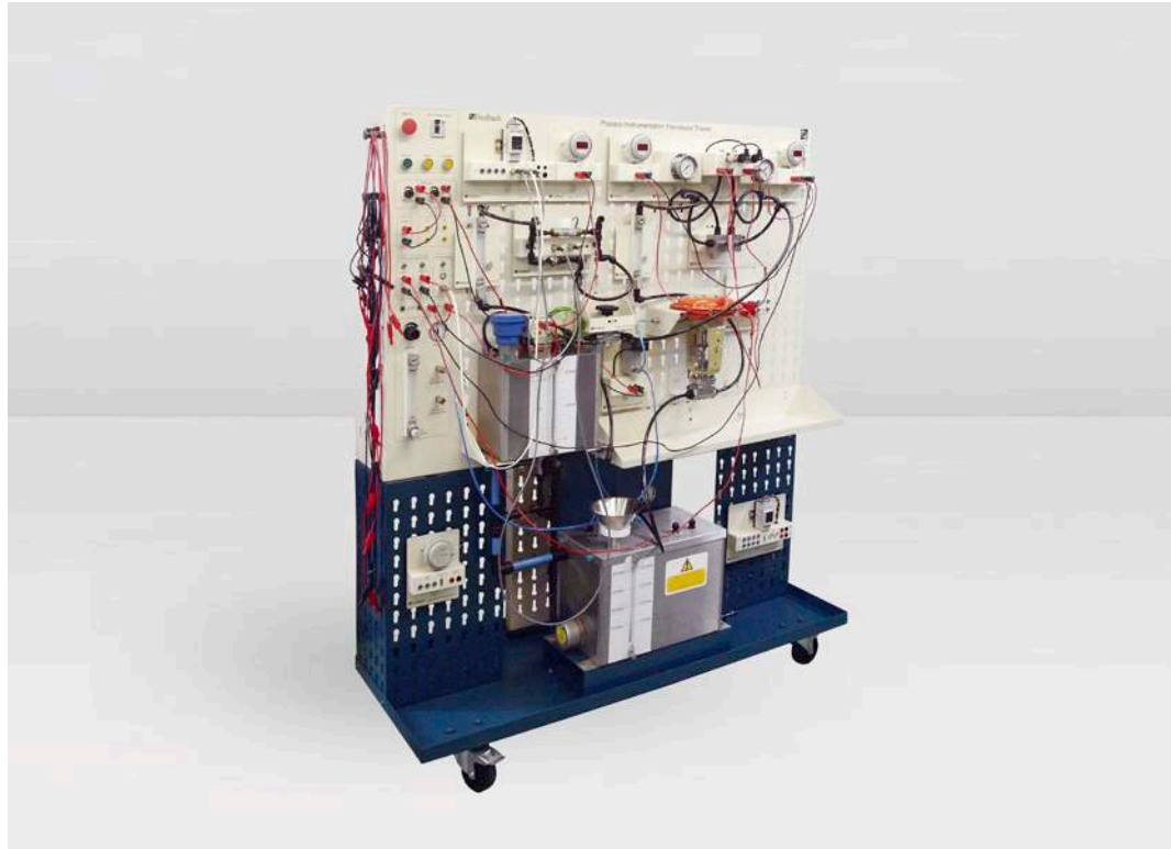
Process Instrumentation (E6.4.2.1)
